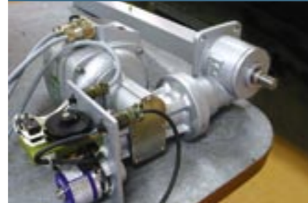
Motoréducteur avec boîtier de fin de course et codeur, montés sur verin
