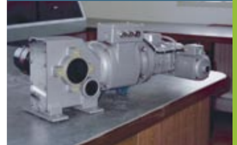
Ensemble motoréducteurs à 3 vitesses avec embrayage
